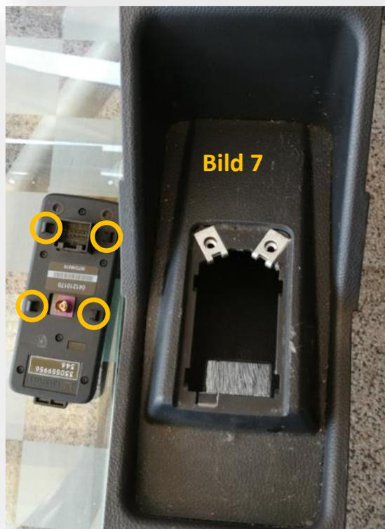
Jetzt kann man die 2 Schrauben der Halterung ( Bild 5 ) entfernen und wenn man möchte, nach lösen der 4 Stecknasen (z.B. mit kleinem Schraubendreher), die Halterung abnehmen ( Bild 6 + 7 ).
